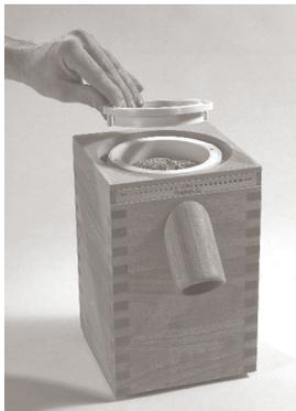
5. Plexiglaszylinder auf den Unterteil des Siebaufsatz aufsetzen, dabei rasten die 2 Kugeln in den Vertiefungen am Zylinder ein, dazu eventuell den Zylinder etwas drehen.
