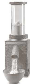
6. Siebaufsatz an Stelle des Trichters eine Umdrehung auf die Mühle schrauben
